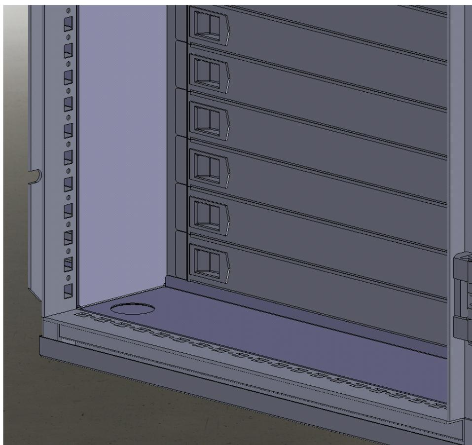
图 18 机柜内部进风侧挡风板效果图
