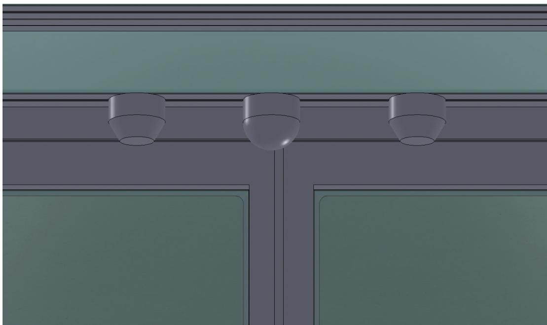
图 40 冷通道内摄像头、温度传感器、烟雾传感器安装示意图
