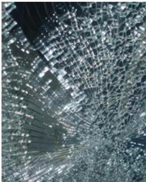
图 31 贴膜钢化玻璃破碎实物图
