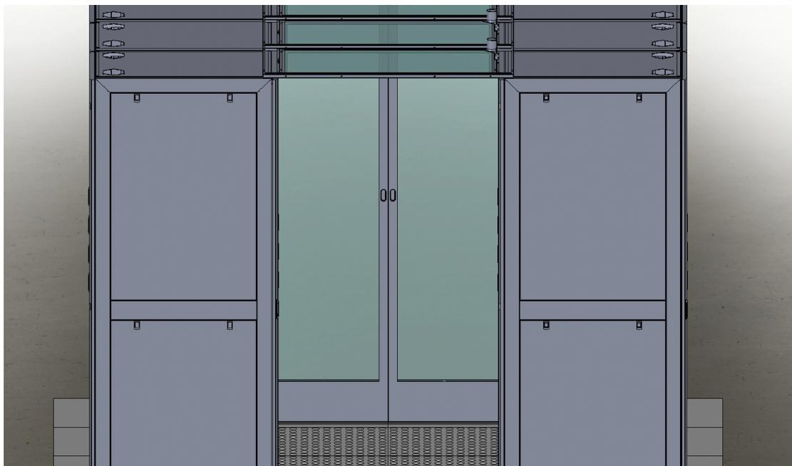
图 28 冷通道内的自动门内嵌拉手安装图
